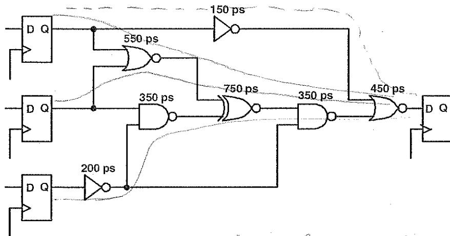
a)  $t_{logic\ max} = 550 \text{ ps} + 750 \text{ ps} + 350 \text{ ps} + 450 \text{ ps} = 2.1 \text{ ns}$
